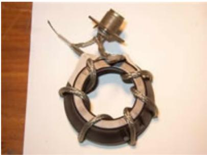
Também experimentei um balun feito sobre núcleo retirado de transformador de saída horizontal de TV/monitor ("fly-back").
