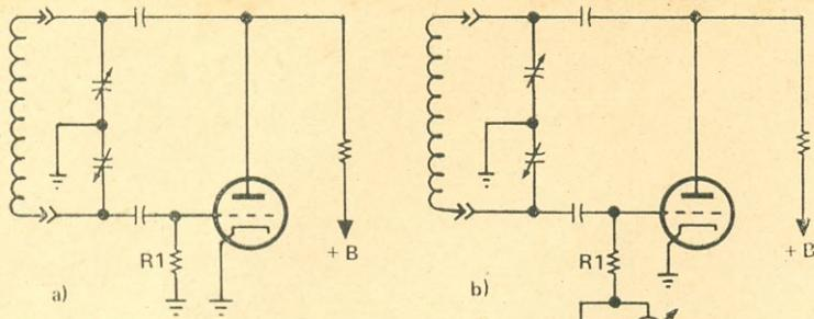
FIG. 1 — Em a) temos um modelo Colpitts de um O.F.V. valvulado, e em b) a inclusão de um medidor, transformando-o em ressonímetro.
