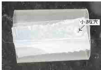
Mesmo fio esmaltado - Germanium como aqueles usados no rádio o ( $\varphi = 0.4\text{mm}$ ) por esse buraco vamos envolto 30 vezes no total da linha (NT: *30 espiras*). É difícil tomar que não está ferida de volta a bobina para a bateria, mas já não vai faltar mais tarde e ficar envolto em todo o bateria. 10 vezes colocar desconecte mudando um pouco onde ele feridas, também de modo que você vai ferida.
