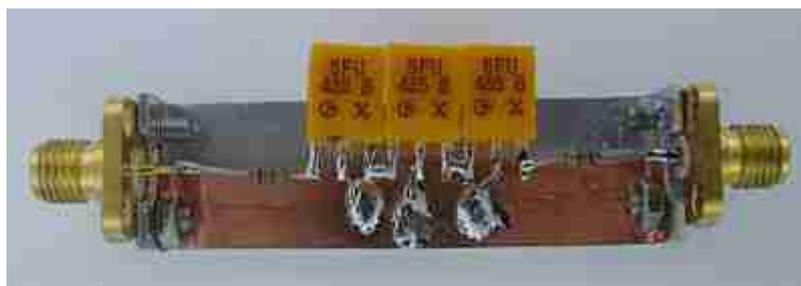
Medido por ligação de um filtro cerâmico de três estágios
