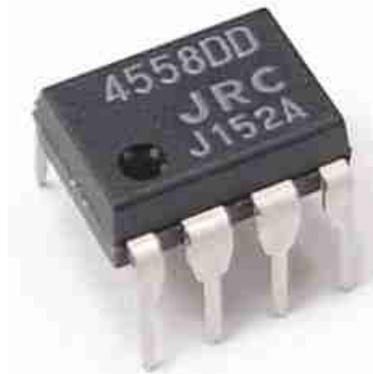
Com este Amplificador OP (amp) você pode fazer um monte de circuito, como uma calculadora analógica, é claro: oscilador, filtro ativo. E quando você usa a entrada não inversora (-) a saída será (+); e quando você utiliza a entrada não inversora (+) a saída será (+).
