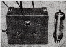
Vista externa da unidade transistorizada comparada com uma válvula miniatura.
