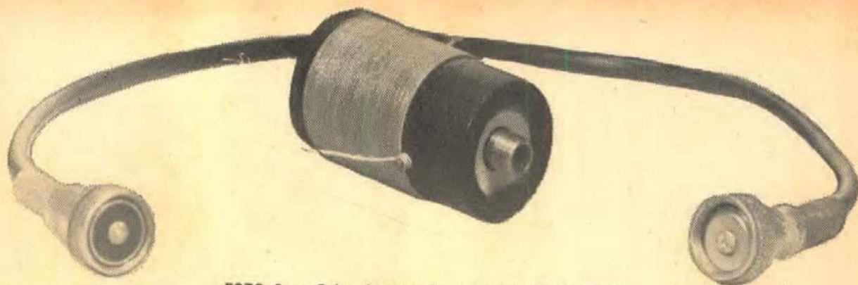
FOTO 2 — Cabo de conexão e bobina do Mausoléu.
