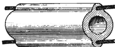
Figura 2.39. Aspecto de un cable de emisión americano "Amphenol" 300 Ω cilíndrico.
