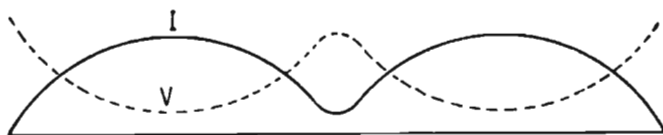
Figura 2.44. Reparto de I y V en una antena de onda entera sin tener en cuenta las fases.
