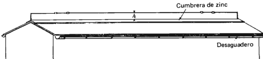
Figura 3.3. Disposición a evitar, a menos que h sea grande.
