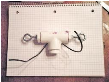
Figura 18 - fotos de K4ICY e WB0JNR – isolador central para dipolo
