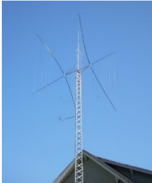
Figura 23 - Antena "Cubica de Quadro" com dois elementos. Porém pode-se verificar que em cada suporte em X, há cinco antenas (fios), portanto tratam-se de cinco cúbicas dividindo o mesmo sistema de sustentação.
