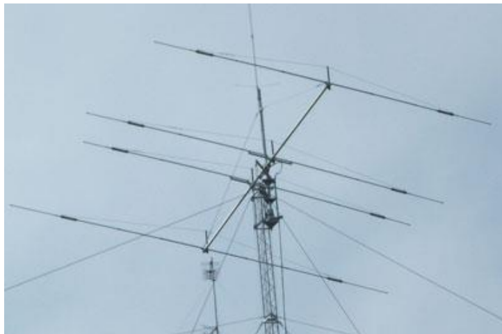
Figura 21 - Yagi encurtada e multibanda, para 10, 15 e 20m com 4 elementos. Podemos ver uma vertical no topo do mastro. As “bobinas” nos elementos tem múltiplas funções.
