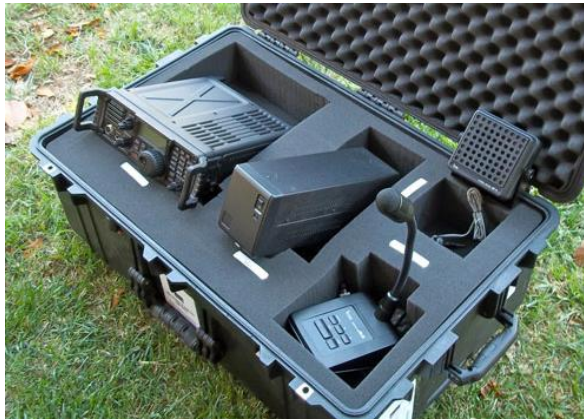
Figura 2 – Exemplo de um conjunto de equipamentos: rádio, microfone e fonte. Faltam: a antena e alguns acessórios na foto, ou seja: ainda não é uma estação. (cortesia de K2BSA & ICOM Inc. – IC-7200, PS-126 & SM-50).
