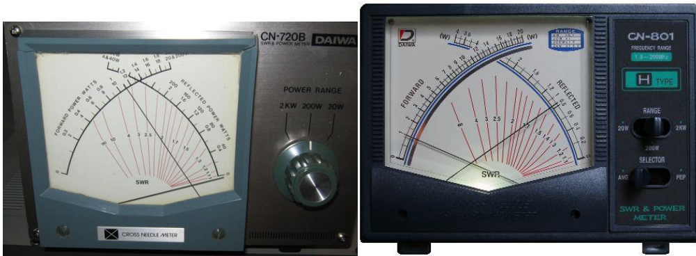
Figura 13 - Medidores de estacionária comercial, fabricados pela Daiwa Co. A escala esquerda mede a potência direta e a escala direita a potência refletida.
