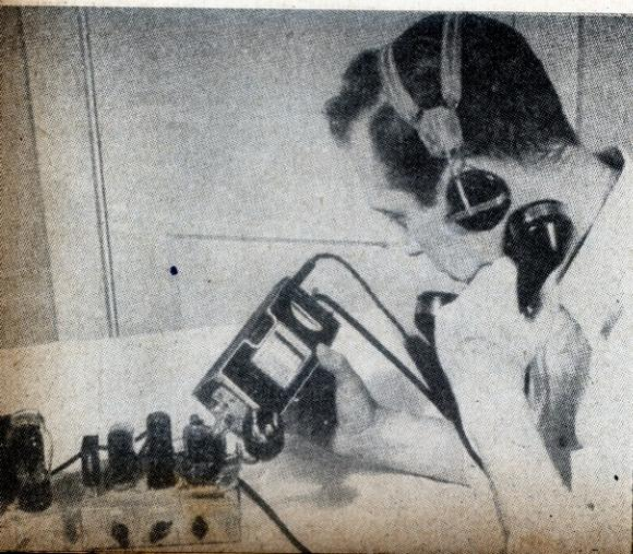
Aqui W2SPV está usando o IDG como um detetor não oscilante para verificar a qualidade de modulação do seu transmissor de 144 Mc. A bobina do instrumento foi colocada bem perto da bobina final a fim de ficar assegurado que realmente o sinal de saída é o que estava sendo monitorado. A caixa cilíndrica ligada aos bornes de antena do transmissor é uma "antena-fantasma".
