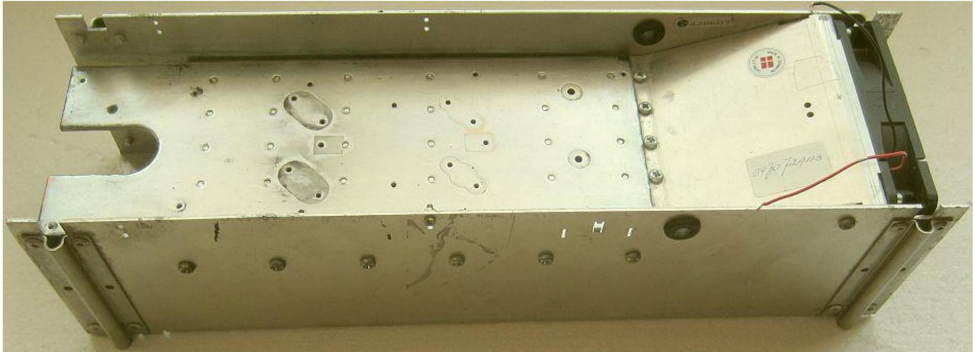
**Dissipador de calor com um ventilador de Sailor canal de navegação. O dissipador de calor parece Alu, mas é uma liga de cobre e zinco.**
