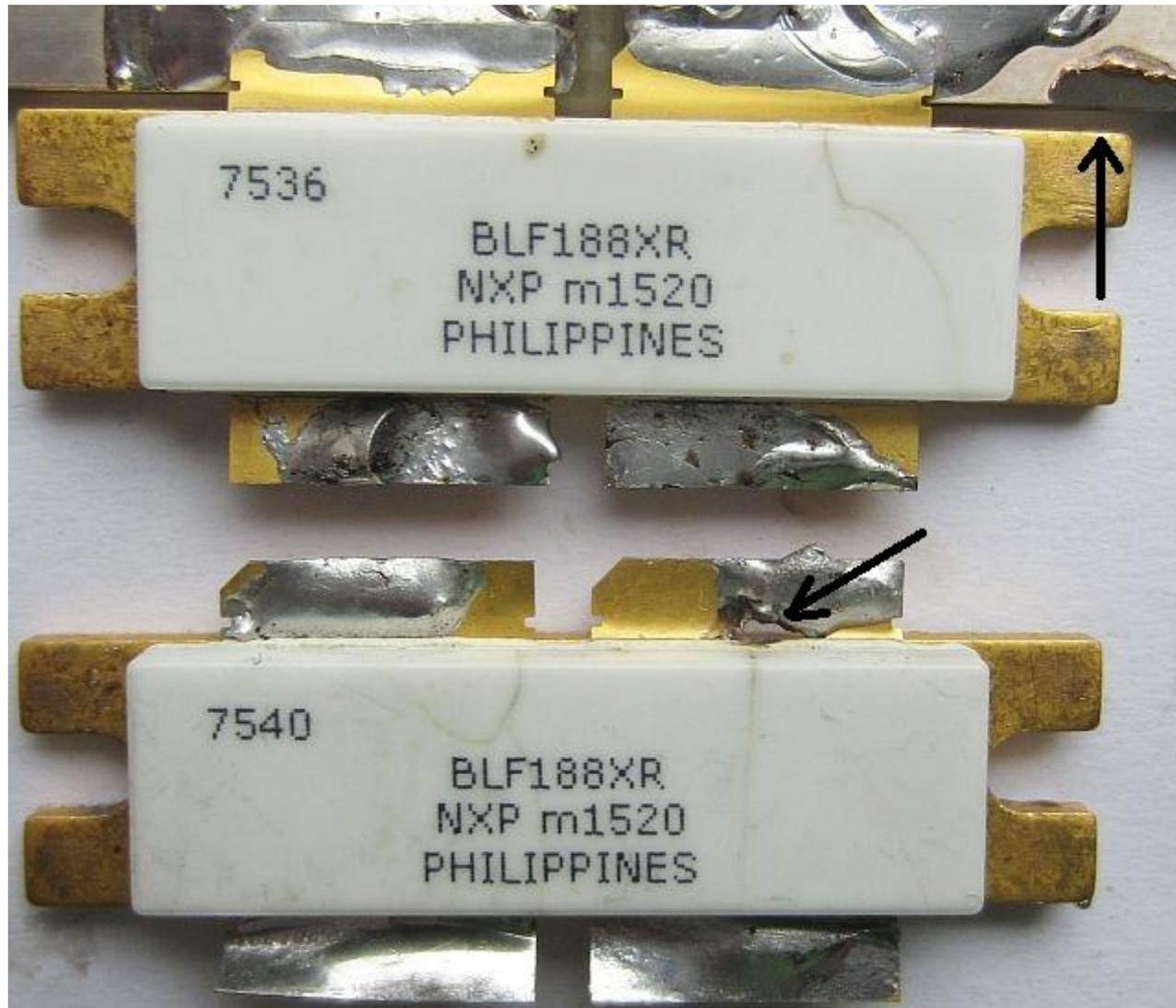
O FET superior foi com cerca de 600W a 40m quebrado com um LPF para 80 m. Houve fásca se efectua entre dreno e do solo, deste modo claramente superiores à máxima tensão de drenagem.
