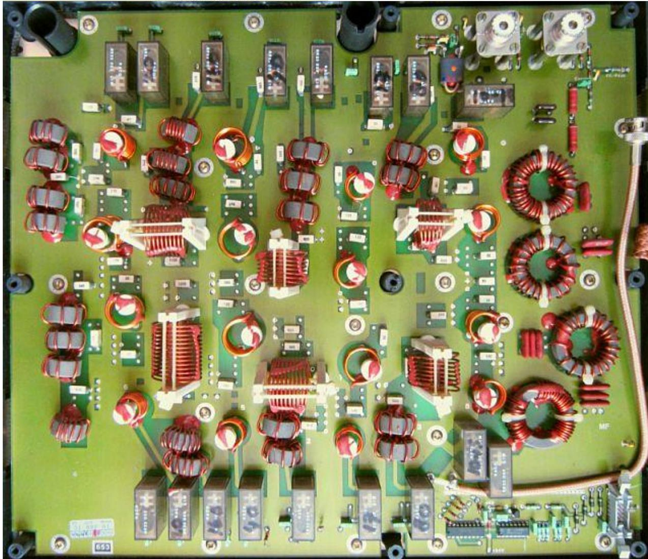
Em lugar de um filtro passa-baixo comutável (LPF) na saída, é utilizada para o tempo ser um pi-filtro ajustável a fim de obter uma melhor adaptação por banda. Além disso, tenho o material antes que os anos recolhidas atrás ( <<figo).
