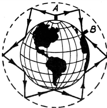
FIG. 11. — Forma como se produce el eco electromagnético.
