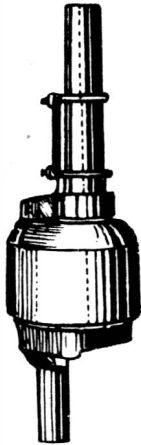
FIG. 232. — Tipo de rotador de antena con motor eléctrico.
