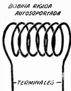
Fig. 249. — Las bobinas autosoportadas se hacen con alambre rígido.
