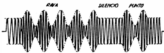
FIG. 17. — Forma de onda de las señales del tipo A_2 para comunicaciones radiotelegráficas.
