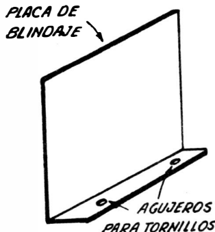
FIG. 255. — Para asegurar al chasis una chapa de blindaje se le dobla una aleta.
